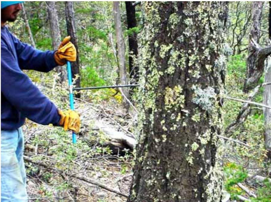
**Figura 2. Obtención de un núcleo de crecimiento con un taladro de Pressler. Observe que el taladro debe tener una posición perpendicular al tronco y aproximadamente a la altura del pecho.**
